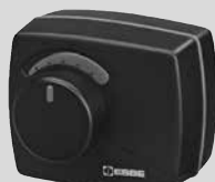
ПРИВОД 3-ХОДОВОГО КЛАПАНА 230В/50Гц время полного хода 120 с90° DN20 – DN50
